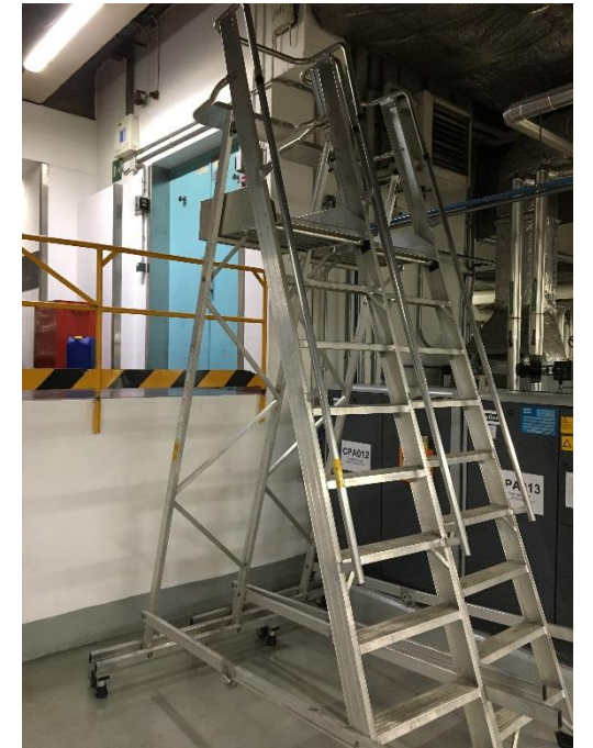
Scala doppia carrellabile con piattaforma e guardacorpo
