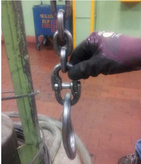
Figura 12 A sinistra esempio di accessorio gravemente danneggiato. A destra esempio di controllo di alcuni accessori di sollevamento
