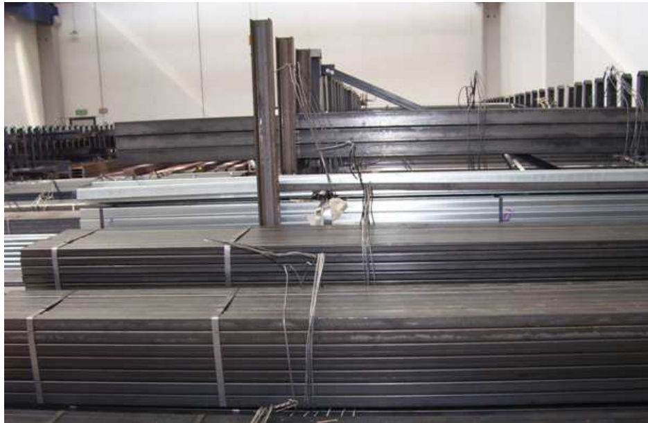
Figura 9 esempio di carichi legati da tondino metallici (sinistra). A destra uso corretto di idonei accessori di sollevamento
