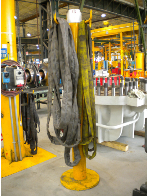
Figura 11 esempio di rastrelliera per il deposito degli accessori di sollevamento
