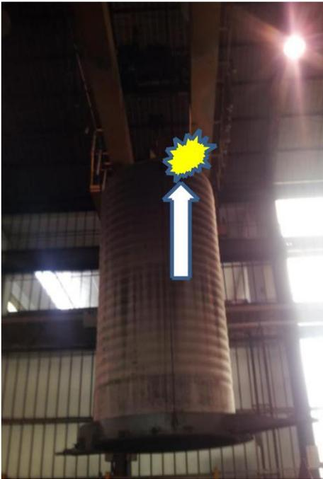
Fig. 1 simulazione incidente con carico caratterizzato da altezza notevole. In tali situazioni il carico appropria al limite superiore ovvero nella zona di intervento del relativo fine corsa.
