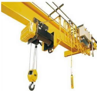
Tipo fisso (Gru a ponte)
