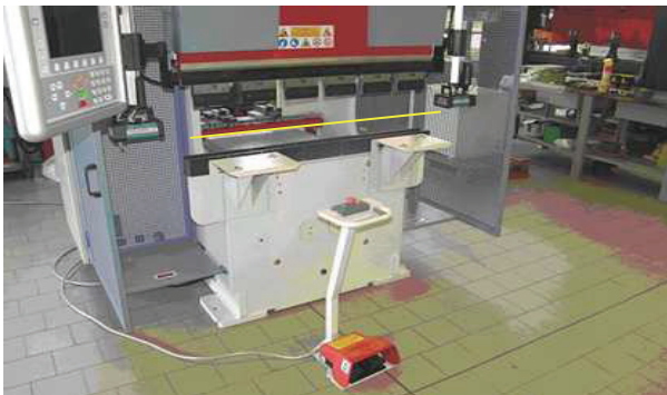
Fotocellula multiraggio laser - visione d'insieme
